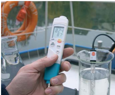
Compensation automatique de temp. grâce à une sonde externe et un capteur de température.
