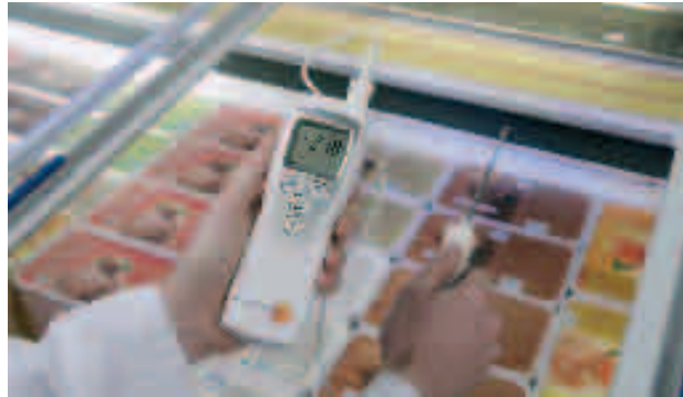
Mesure de température ambiante dans les vitrines réfrigérées et congélateurs
