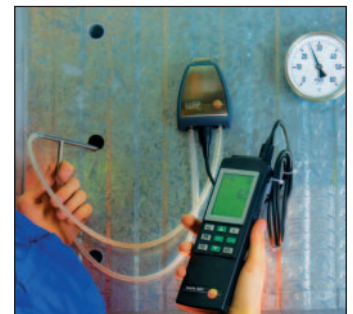
Mesure tube de Pitot avec sonde externe 100 Pa
