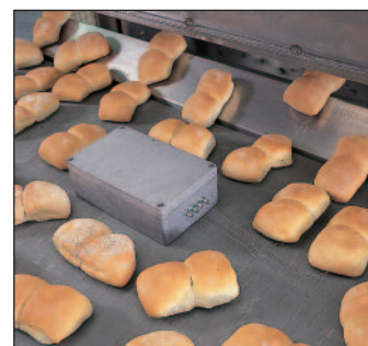
Contrôle de température en phase de cuisson
