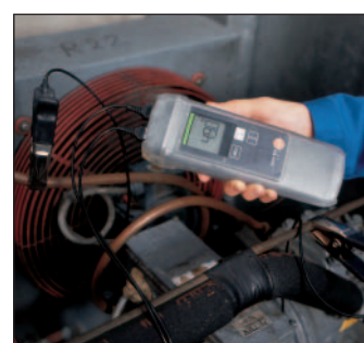
Mesure de surchauffe ou de refroidissement d'installation frigorifique
