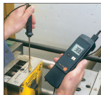
Température de surface sur un moule (machine à injection)
