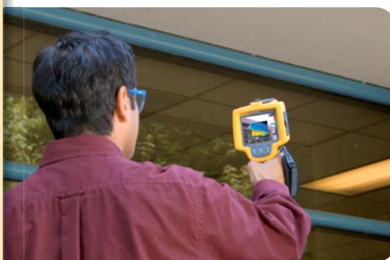
Toitures : détectez les isolations gonflées d'eau dans les systèmes de toiture-terrasse pour localiser les parties endommagées de la structure du toit.
